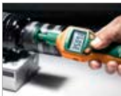
Medición de rpm con contacto
