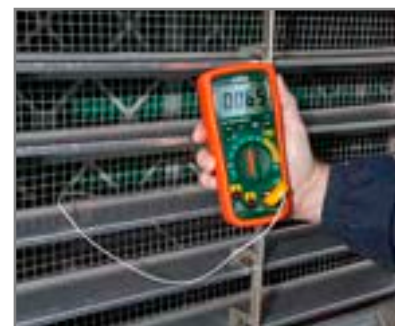
Comprobación de la salida de temperatura en unidades de climatización con el modelo EX355
