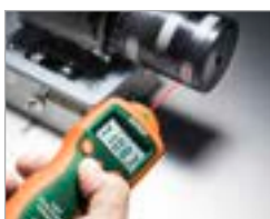
Medición de rpm por foto con láser
