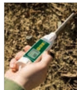
Incluye sonda de humedad de acero inoxidable de 20 cm (8").
